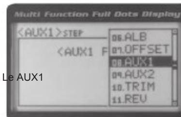
3) Appuyez sur la touche ENTER, puis faites défiler pour changer la position auxiliaire 1 valeur. L'augmentation de la valeur vers le haut côté (H) ou basse côté (L) provoquera l' Auxiliaire 1 servo de se rendre à cette position spécifique lorsque vous activez l'auxiliaire 1 étape fonction.
