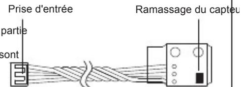
Installez le capteur RPM dans votre modèle, en s'assurant qu'il est solidement maintenu en place. Pour un fonctionnement optimal, le capteur Ramassage doit se situer environ 1 mm à une distance de l'arrière de la partie mobile (volant moteur, l'engrenage droit, etc)
