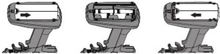
2) Installez quatre piles neuves 'AA' Alcaline dans le support de batterie, en s'assurant que la polarité est correcte. La direction dans laquelle chaque batterie doit être installé est moulé dans le fond du support de la batterie (+ positive et - Negative).
