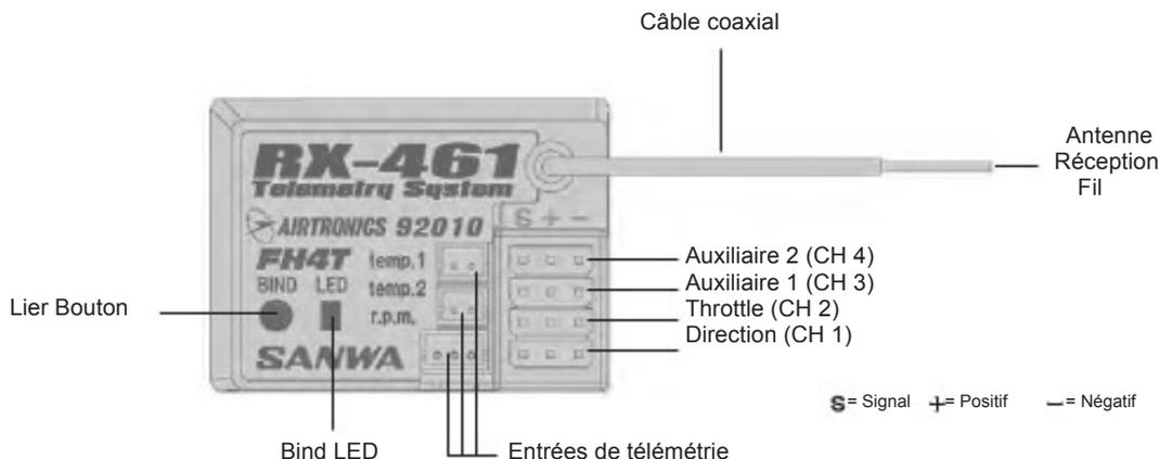
⚠ La batterie du récepteur peut être branché dans n'importe quel emplacement de canal pour alimenter le récepteur. Pour utiliser tous les canaux et une distincts
