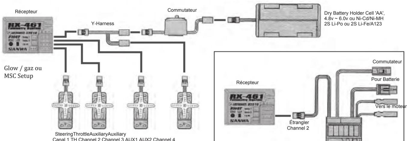
⚠ Ne pas utiliser servos prévus pour 4,8 ou 6,0 volts avec une 2S Li-Po ou Li-Fe/A123 batterie de récepteur ou d'endommager les servos pourraient en résulter.
