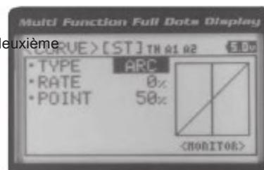
Plage de réglage du type de courbe est EXP et ARC. Le réglage par défaut est EXP.
