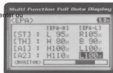
L A1 EPA et EPA A2 plage de réglage L est de 0% à 150%. Le réglage par défaut est de 100%.
