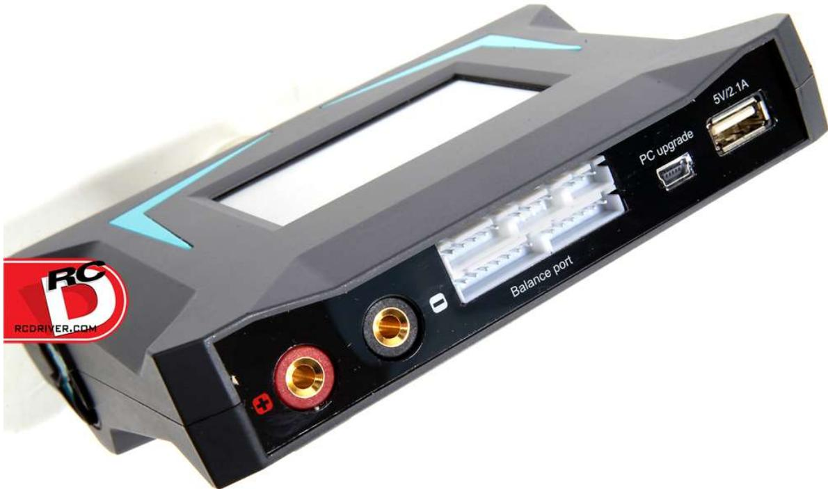
Il peut charger dans différents modes jusqu'à 8,0 ampères, idéal pour charger des packs de batteries de grande capacité qui deviennent peu à peu la norme. Pour les packs au lithium, le X100 peut charger, charger rapidement, équilibrer la charge (la méthode la plus courante utilisée) et décharger. Quant aux batteries NiMH et NiCd, le X100 peut charger, décharger et charger les packs en cycle.
