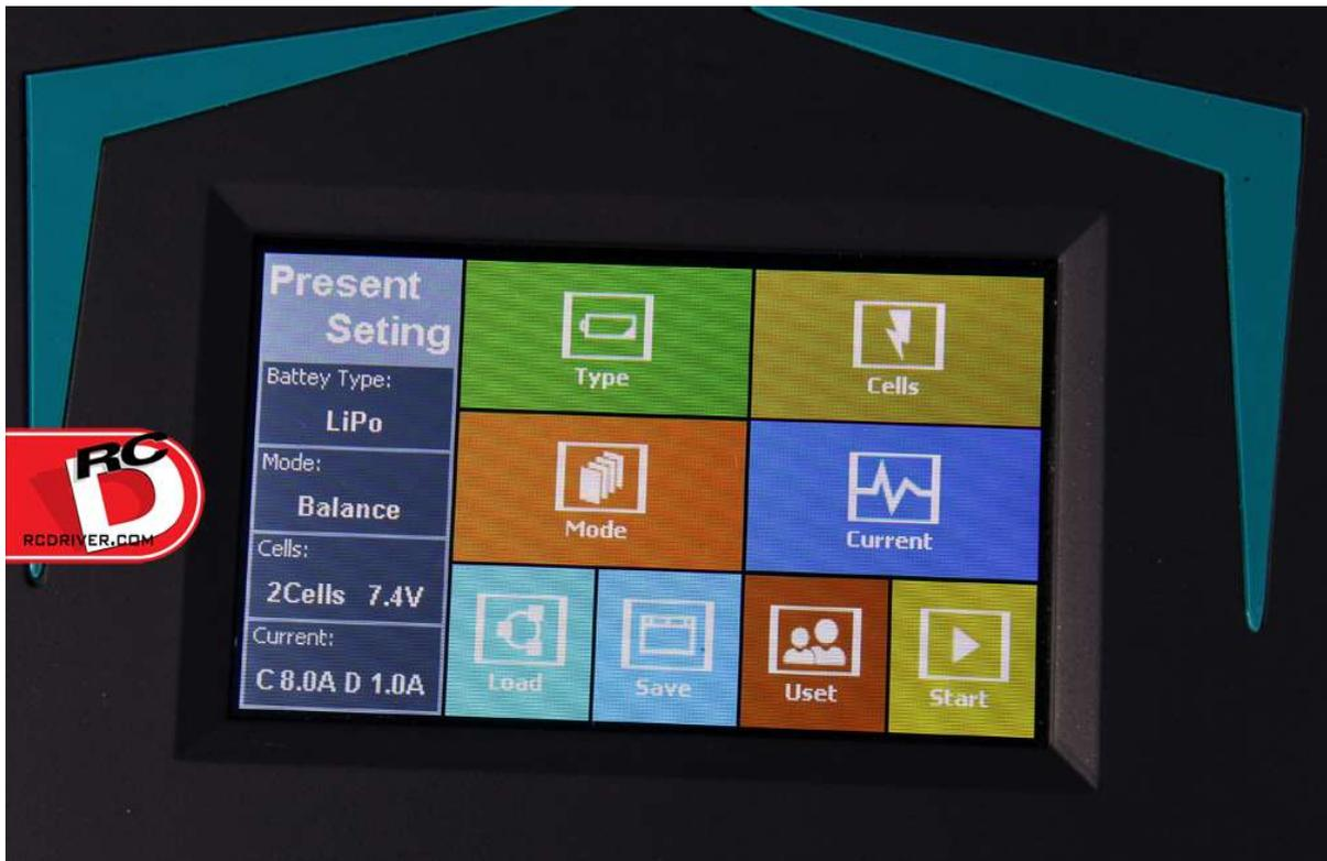
Appuyez sur « Type » pour ouvrir un nouvel écran, vous offrant six options de batterie : LiPo, NiMh, LiIon, NiCd, LiFe et Pb. Une fois le type de batterie souhaité sélectionné, le chargeur revient à l'écran principal.
